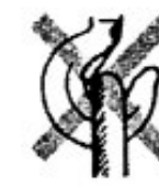
El pestillo de seguridad no funciona apropiadamente
