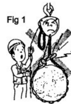
La estructura de soporte o la banda esta apoyada en un punto impropio del gancho
