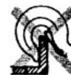
La punta del gancho torcida muestra la carga
