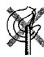
La estructura de soporte o la banda esta apoyada en un punto impropio del gancho
